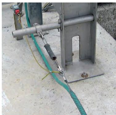
Leitungsziehstrumpf, doppelte Öse DB | vertikale Anwendungen, normaler Betrieb
