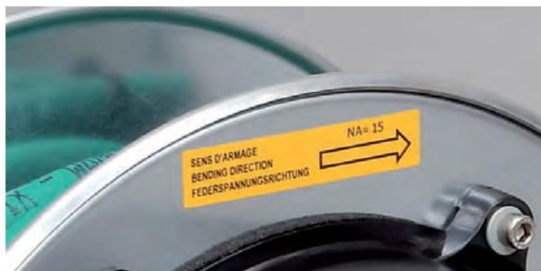
Die Leitungstrommeln werden mit nicht vorgespanntem Federmotor geliefert (außer Optionen BR und SP). Der Motor muss, was die Richtung und die Anzahl Vorspanndrehungen ‚NA‘ betrifft, beim Aufbau wie auf dem Trommelkörper der Leitungstrommel angegeben gespannt werden.
