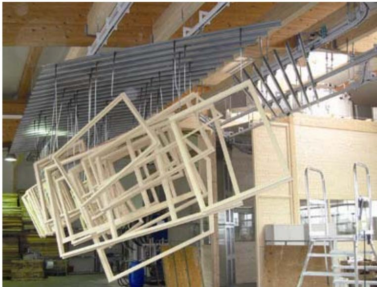
*BU: Die Power & Free Lösung von Conductix-Wampfler wird u.a. in der Holzlackierung eingesetzt. Eine Querpufferung sorgt dabei für den geringen Platzbedarf.*
